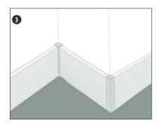
Bis zur vollständigen Durchtrocknung des Klebers die Leiste fixieren, um verrutschen zu vermeiden.
