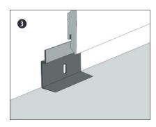
An der Stelle wo die Leisten zusammentreffen, sollte ein Clip montiert werden, um die Schnittstelle zu stabilisieren.
