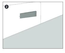
Der Ort der Einschussstelle so unauffällig wie möglich wählen. Gegebenenfalls sichtbare Löcher verschließen.
