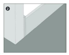
Bei der Verwendung von Eckstäbchen diese nach dem Kürzen ebenfalls festkleben.
