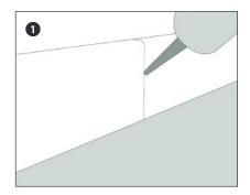
Aus ästhetischen und hygienischen Gründen mag es sinnvoll sein die Gehrung sowie die Ober- und/oder Unterseite mit einem geeigneten Dichtstoff zu versiegeln.
