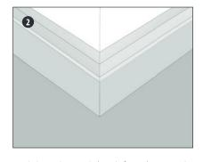
Nachdem der Winkelgrad festgelegt wurde, mit Kappsäge entsprechend zuschneiden beispielsweise bei Außenecken.
