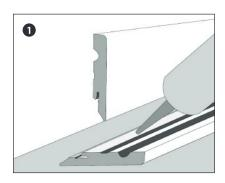
Montagekleber gleichmäßig auftragen. Die Verwendung von Silikon ist nicht zulässig.
