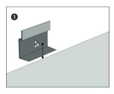
Die Verpackung dient als Montagehilfe zur Ermittlung der Höhe für die Bohrlöcher. Der Clip kann auch festgeschossen oder festgeklebt werden.
