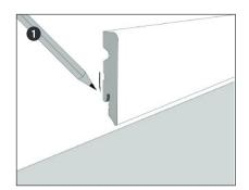
Leiste an der Wand anlegen und anzeichnen oder entsprechend mit Metermaßstab nachmessen und markieren
