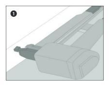
Sockelleiste nach dem zuschneiden mit "Stauchkopfnägeln" aus dem Druckluftnagler befestigen.
